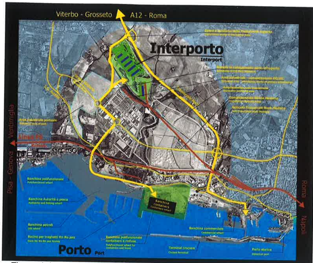
Figura 4.4 Interventi previsti per il Porto di Civitavecchia
